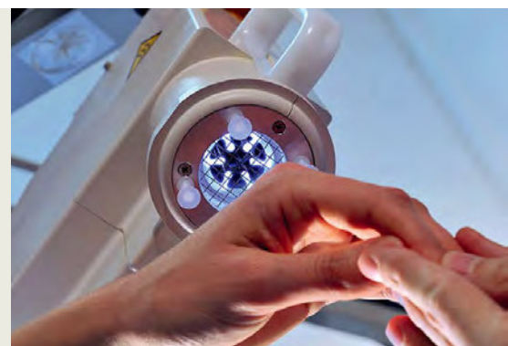
Mit dem fahlblau leuchtenden kalten Plasma lassen sich unter anderem Wunden effizient desinfizieren.
