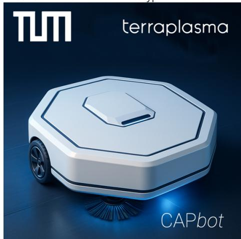
Pressebild 2: CAPbot - Prototyp eines mobilen Reinigungsroboters mit plasmaaktiviertem Nebel
